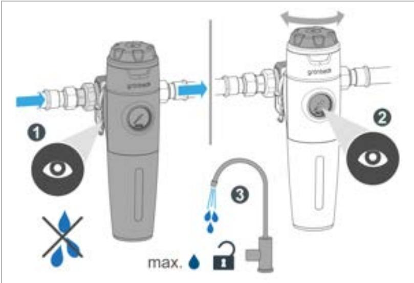
1. Prüfen Sie die Installation auf Dichtheit und Funktion.
