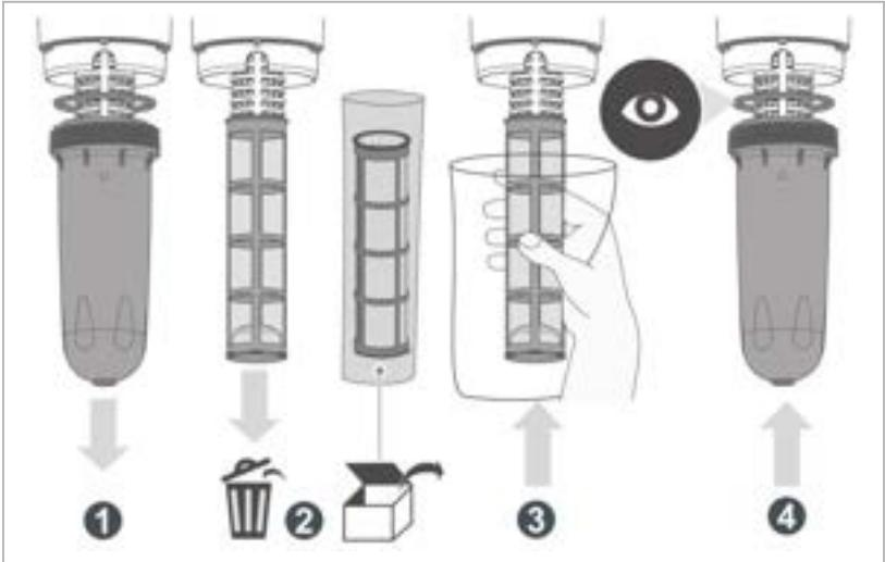
1. Ziehen Sie die Filterglocke und den O-Ring ab.
