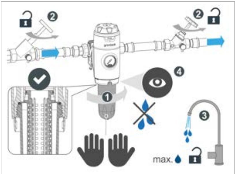
1. Prüfen Sie, ob die Filterglocke bis zum Anschlag im Filterkopf eingeschraubt ist.
