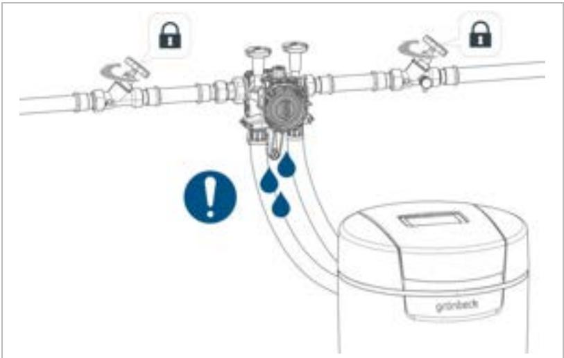
1. Schließen Sie das Absperrventil vor dem cliQlock-Modulsystem.
