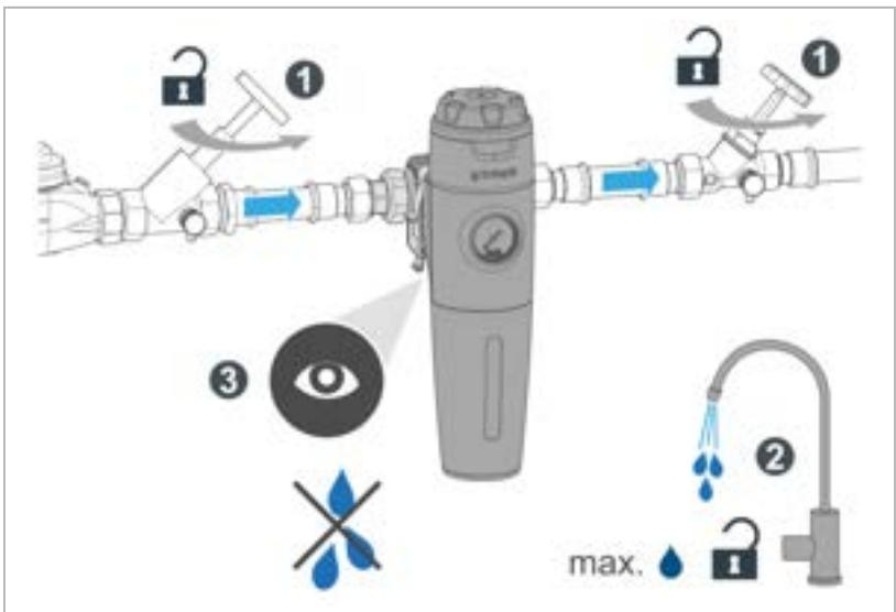
1. Öffnen Sie die Absperrventile.
