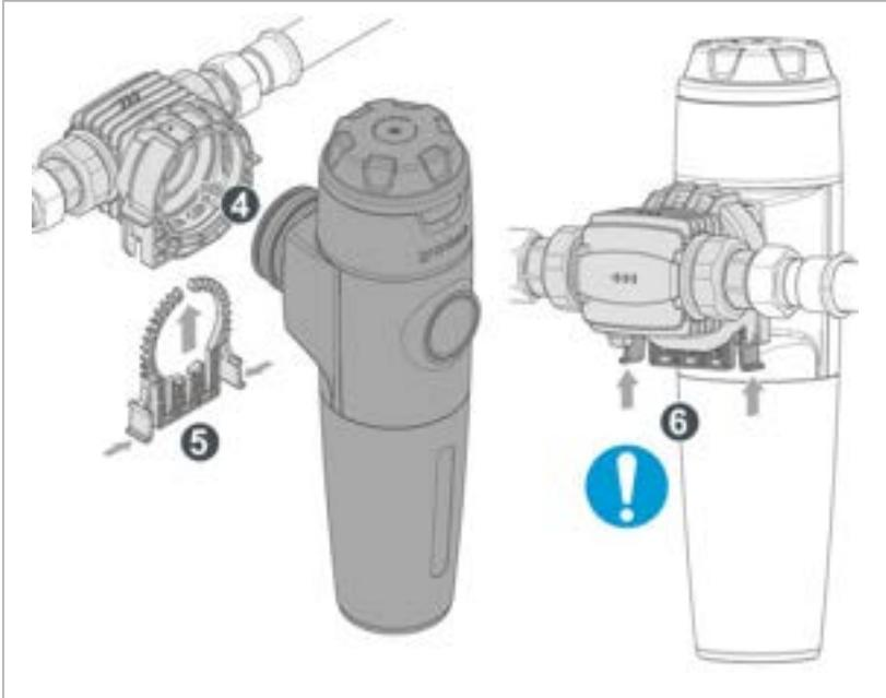
4. Stecken Sie den Filter mit der Steckkupplung bis zum Anschlag in das cliQlock-Basismodul.
