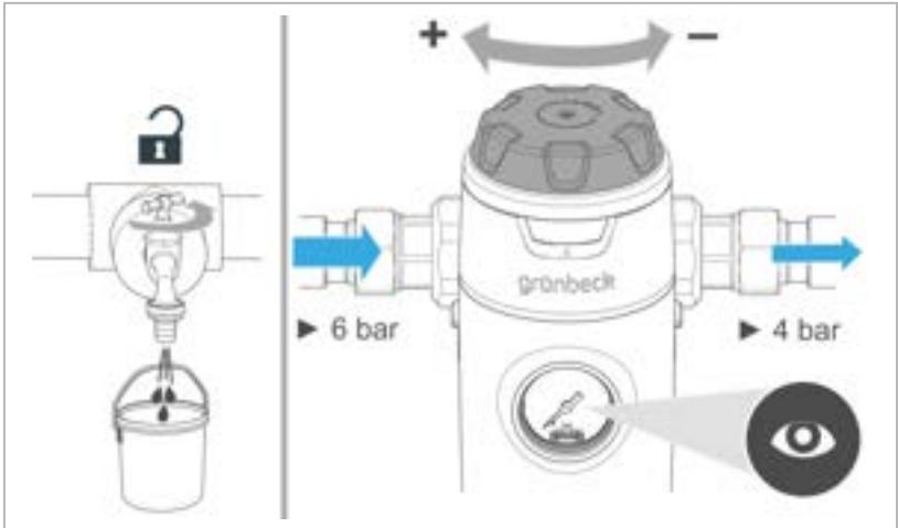
1. Stellen Sie den gewünschten Nachdruck am Druckminderer-Handrad ein (links drehen = Druckerhöhung, rechts drehen = Druckreduzierung).
