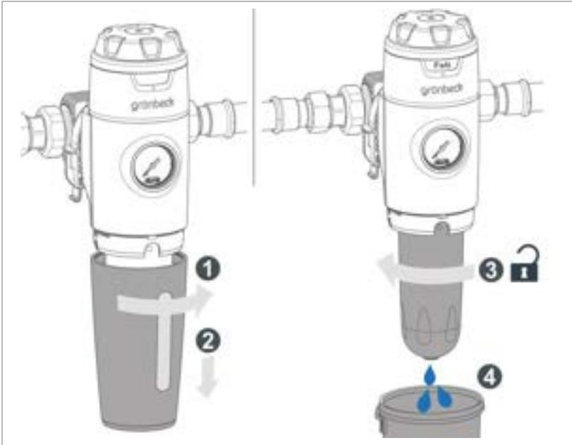
1. Drehen Sie die Filterglockenabdeckung nach rechts oder links.
