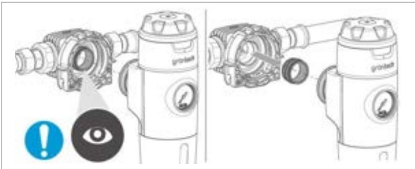
1. Ziehen Sie die Steckkupplung aus dem cliQlock-Basismodul von Hand heraus – kein Werkzeug benutzen.
