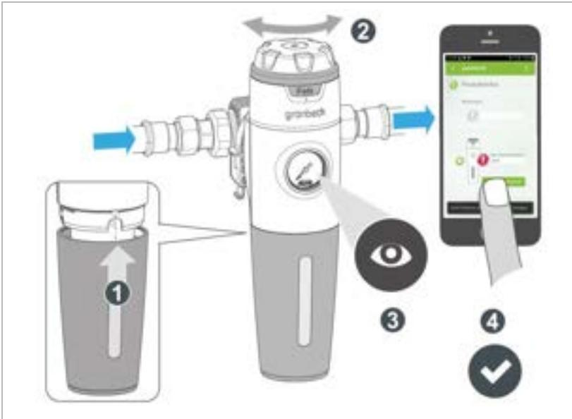
1. Setzen Sie die Filterglockenabdeckung mit dem Sichtfenster nach vorne an.
