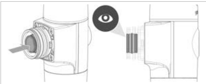
2. Stecken Sie die Steckkupplung bis zum Anschlag in den Anschluss des Filters.
