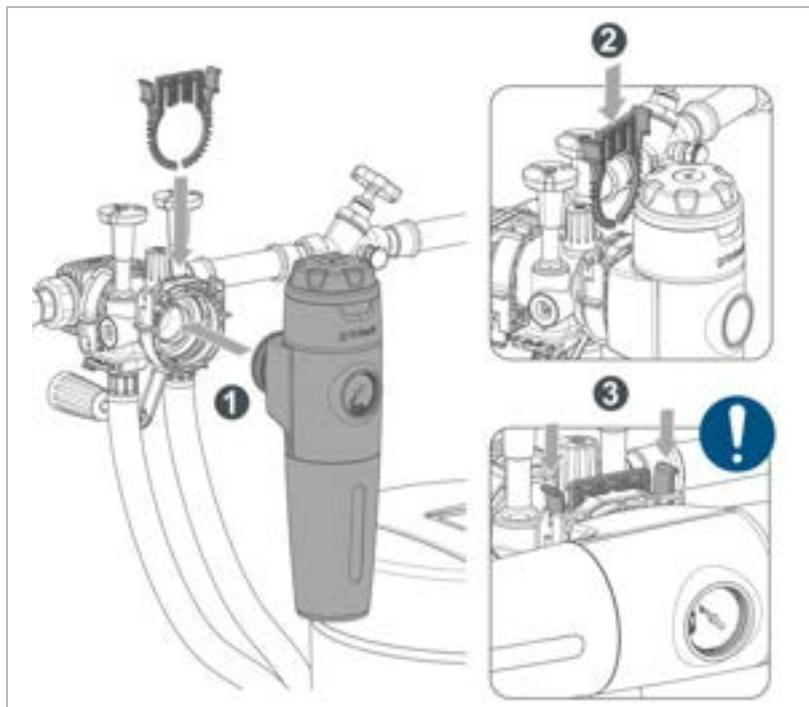
1. Stecken Sie den Filter mit der Steckkupplung bis zum Anschlag in das Anschlussmodul.
