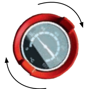
3. Bei 45° ist das Rückschlagventil geöffnet, das Heizkreis-Set kann gefüllt, entlüftet oder entleert werden.
