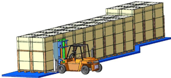
Entladen von längsseitigen vertikalen Verpackungen mit einem Gabelstapler
