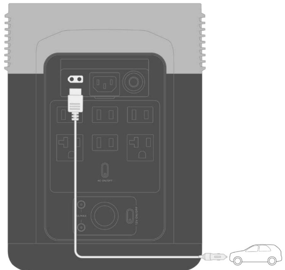
Laden Sie das Gerät erst nach Start des Fahrzeugs mit dem Kfz-Ladegerät auf, um zu vermeiden, dass das Fahrzeug aufgrund einer zu leeren Fahrzeugbatterie nicht gestartet werden kann. Stellen Sie außerdem sicher,
