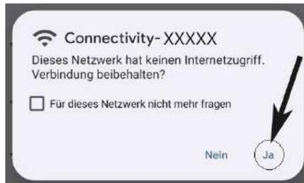
→ Die aktive WLAN-Verbindung *Connectivity-XXXXX* wird angezeigt - das mobile Endgerät ist mit dem WLAN Access Point des Connectivity-Moduls verbunden.
