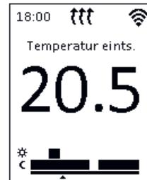
Wenn der Benutzer die Temperatur des Geräts im Automodus ändern möchte, ohne diesen Modus zu verlassen, drücken Sie die Tasten UP oder DOWN und es wird in den modifizierten Automodus gewechselt.
