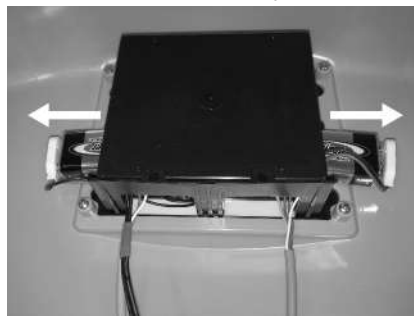
Abb. 14: Blockbatterien für die Notstromfunktion
