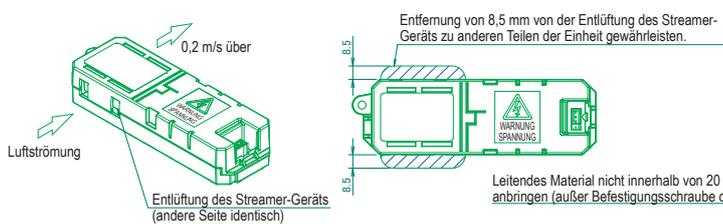
Leitendes Material nicht innerhalb von 20 mm des Aluminiumbandes anbringen (außer Befestigungsschraube der Einheit).
