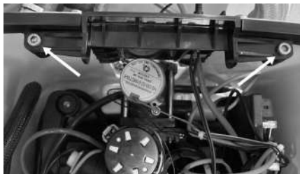
Abb. 13: Schrauben des schwarzen Einsatzes lösen
