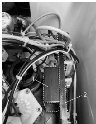
Abb. 17: Connectivity-Modul in Halterung
