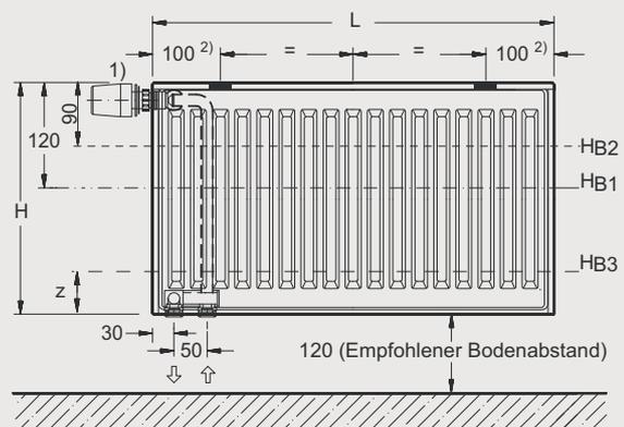
HB1 = Höhe Bohrloch oben Konsole BMSplus FMS/FMX
