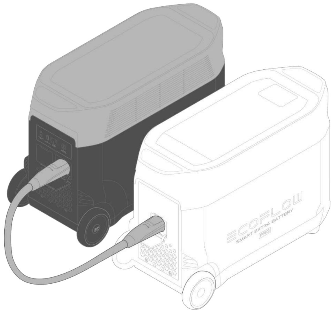
1. Schalten Sie vor dem Anschließen oder trennen sowohl den intelligenten Zusatzakku als auch die DELTA Pro aus.
