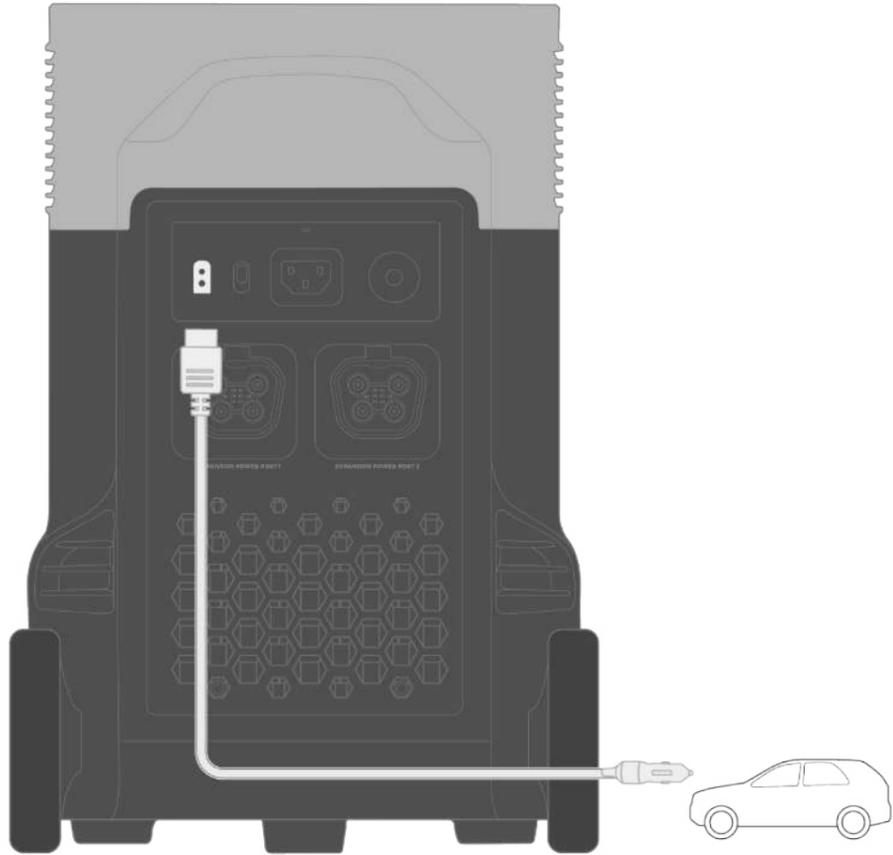
Laden Sie das Gerät erst nach Start des Fahrzeugs mit dem Kfz-Ladegerät auf, um zu vermeiden, dass das Fahrzeug aufgrund einer zu leeren Fahrzeugbatterie nicht gestartet werden kann. Stellen Sie außerdem sicher, dass der Kfz-Zigarettenanzünder und das Eingangskabel des Kfz-Ladegeräts in gutem Zustand sind. EcoFlow übernimmt keine Verantwortung für Verluste oder Schäden, die durch die Missachtung der Anweisungen verursacht wurden.
