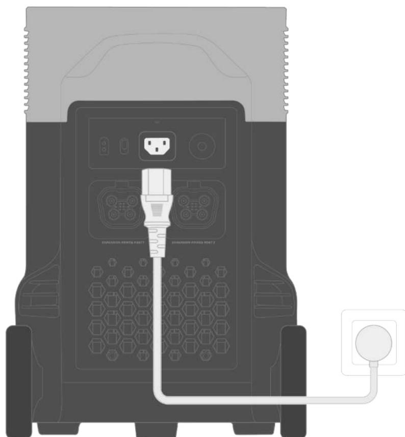
In ungewohnlichen Situationen, in denen der AC-Eingangsstrom uber 20 A bleibt, lost der X-Stream-Ladeeingang eine Selbstschutzfunktion aus, und der Uberlastschuttschalter am Gerat wird automatisch geoffnet. Nachdem Sie bestatigt haben, dass kein Produktfehler vorliegt, konnen Sie den Uberlastschuttschalter drucken, um den Ladevorgang fortzusetzen.
